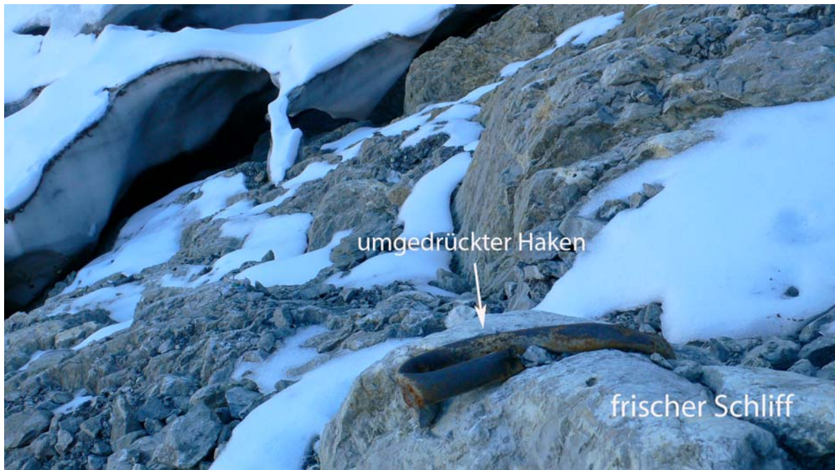
Abbildung 14: dieser Sicherungshaken ist von der Eislast flach gedrückt worden. Photo Hans Aeschlimann.
